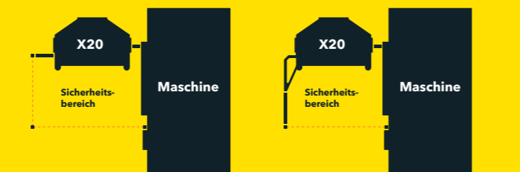
Sicherheitsbereich mit Lichtvorhang und Spiegel.
